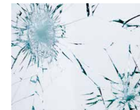
Das Verbundsicherheitsglas bricht trotz Gewalteinwirkung nicht auseinander, das Fenster bleibt geschlossen.
